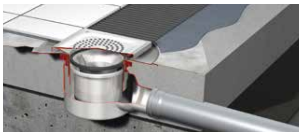
Aansluiting op dampdichte folie.
